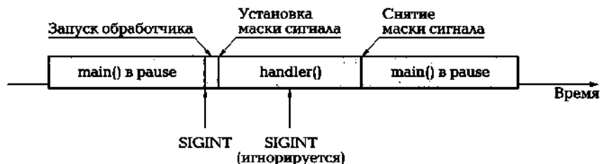
Рис. 10.3. Выполнение процесса при установленной сигнальной маске
